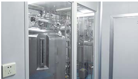
1000L配液罐与250L配液罐 适应不同生产批次需要
