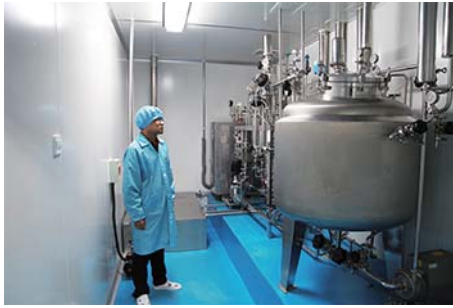
应用了注射针剂专用蒸馏水系统，没有采用成本更低的超纯水系统内毒素更低。
