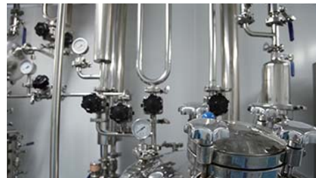
在线清洗与在线灭菌系统（CIP+SIP）
