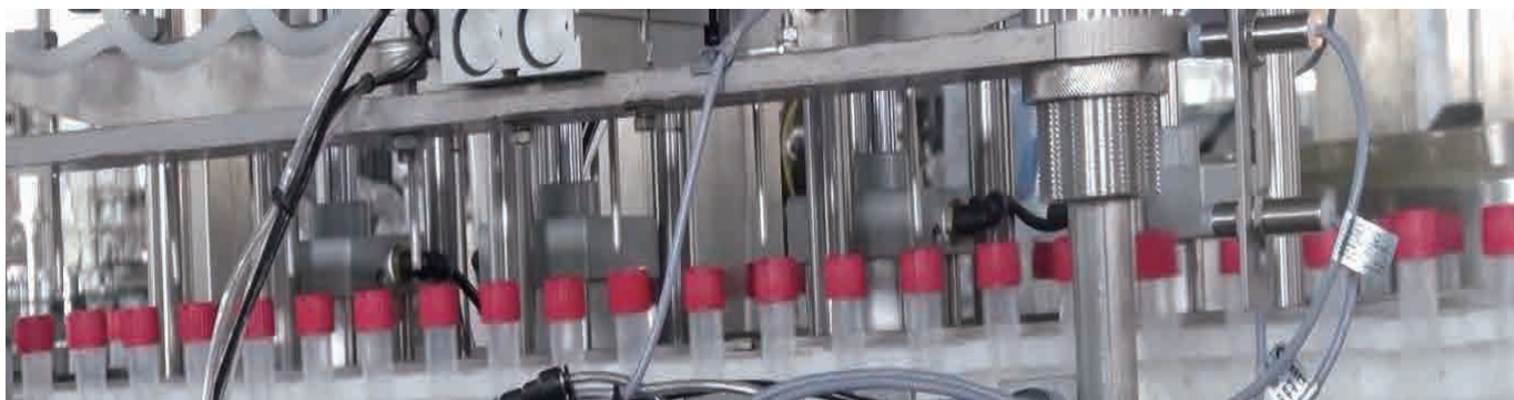
全自动病毒采样管高速灌装线，灌装速度60支/分钟。
