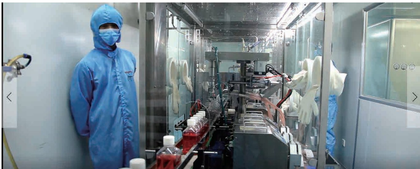
全自动细胞培养基灌装线，灌装速度12瓶/分钟。
